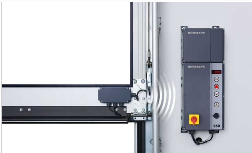
Radijo ryšio perdavimo blokas skirtas perduoti vartų sąvaros signalą „Bluetooth“ ryšiu valdymo įrenginiui (naudojama vietoje spiralinio laido), elektros srovė tiekama iš galingo akumuliatoriaus; prijungiamieji komponentai: optiniai jutikliai „LE“ (vartojantys mažai energijos), anksčiau suveikiantis šviesos barjeras „VL1-LE“ ir „VL2-LE“, „8k2“ juosta, nukarusio lyno jungiklis, durų vartuose kontaktas, naktinio užrakimo kontaktas
